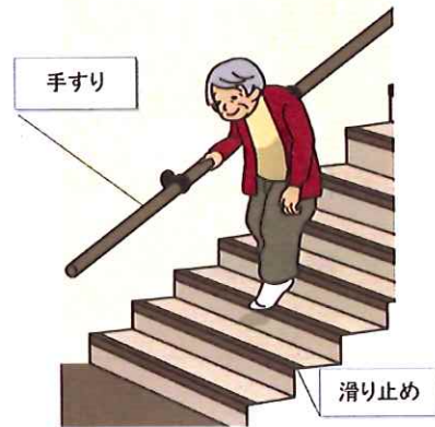
階段からの転落を防ぐ対策
